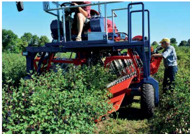
Prototyp samobieżnego kombajnu podczas zbioru świdosiłwy
