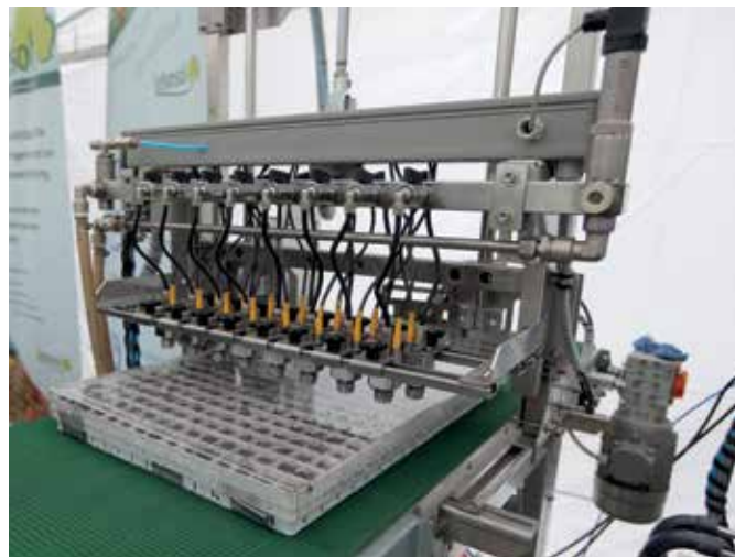
Urządzenie do precyzyjnej aplikacji środka w technologii PHYTO-DRIP
